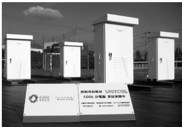
SPACECOOL素材を活用した分電盤の実証実験のもよう
